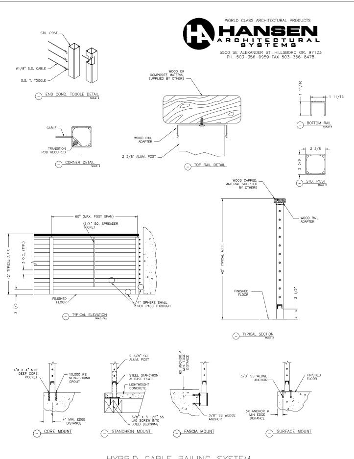
HYBRID CABLE RAILING SYSTEM www.aluminumrailing.com
